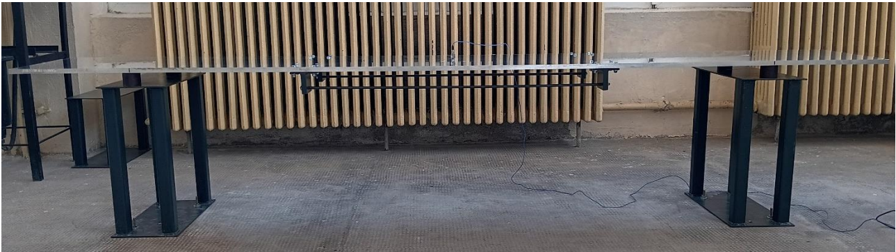
Figura. 2. Ansamblul modelului experimental al cutiei cu bare anti-încovoiere.
